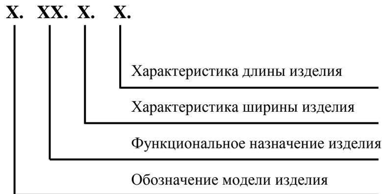
**Расшифровка маркировки прицепов тракторных вагонов-домов передвижных модели "Кедр" на шасси прицепа тракторного:**
